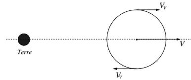
La composition des vitesses donne :  $V_{min} = V - V_v$  et  $V_{max} = V + V_v$ .
