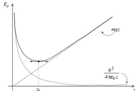
3.a. Il n'y a pas de frottement, donc l'énergie mécanique  $E_m = E_p + \frac{mv^2}{2}$  se conserve. En  $z = H$   $v = 0$
