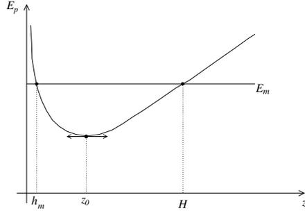
3.b. La bille oscille sur l'axe  $Oz$  entre les deux points extrêmes  $H$  et  $h_m$  où la vitesse s'annule et change de signe pour devenir maximal en module en  $z = z_0$ .
